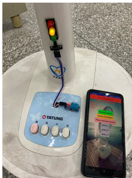
圖 10 這是手機調檔，高速時 LED 顯示紅燈、中速時 LED 顯示黃燈、低速時 LED 顯示綠燈，用戶在 App 按下 Phone Remote Control 之後，按鈕 gears1、gears2、gears3 按了才會有條檔功能之反應，然後 智能控制和手動 不動作。
