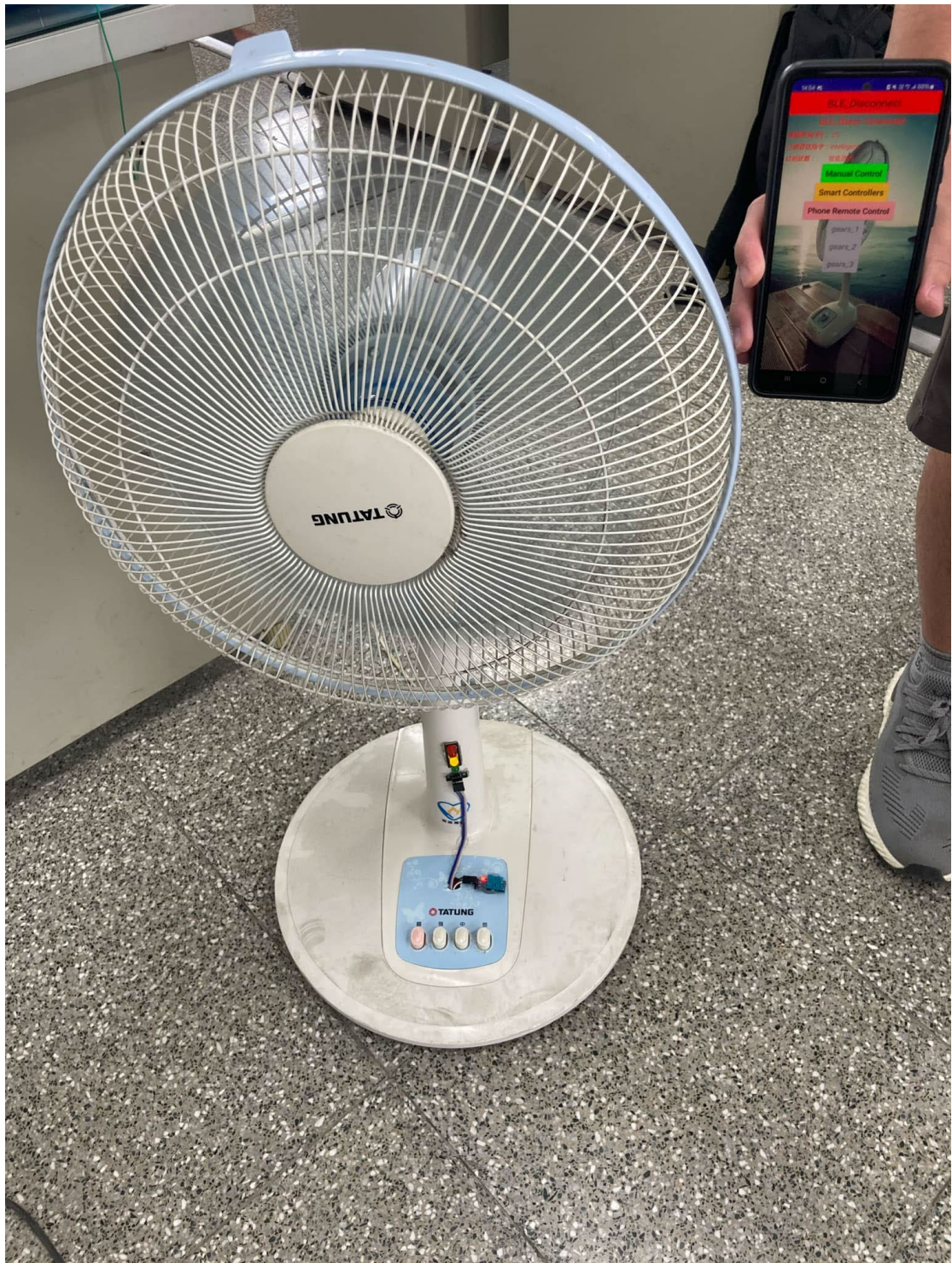
圖 11 這是智能溫度調檔，高速時 LED 顯示紅燈(超過 30^{\circ}\text{C} )、中速時 LED 顯示黃燈( 20^{\circ}\text{C}\sim 30^{\circ}\text{C} )、低速時 LED 顯示綠燈( 10^{\circ}\text{C}\sim 20^{\circ}\text{C} )、 10^{\circ}\text{C} 以下 LED 全滅並且電扇不做動，用戶在 App 按下 Phone Remote Control 之後，gears1、gears2、gears3 按鈕按了才會有調檔功能，然後 手動和 App 控制 不動作。
