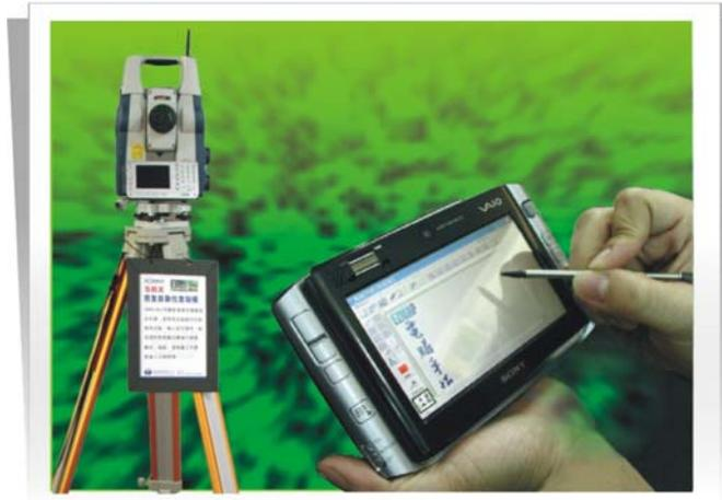
圖 2 數值平板測量的設備
