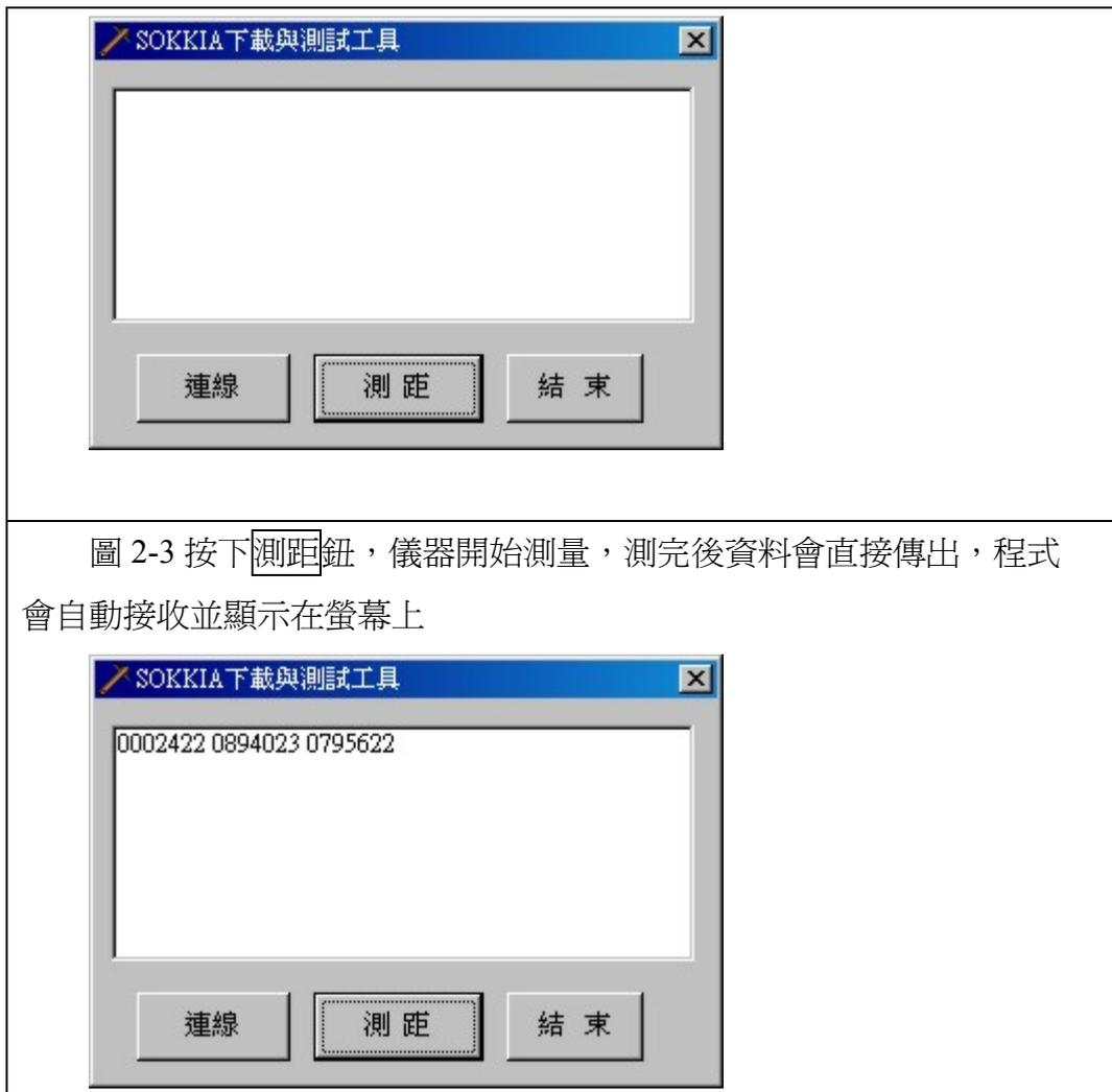
圖 2-3 按下測距鈕，儀器開始測量，測完後資料會直接傳出，程式會自動接收並顯示在螢幕上
